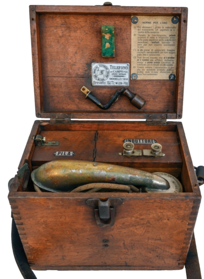
Apparato telefonico da campo S.I.T.I. Modello 1916 del Regio Esercito Italiano.
