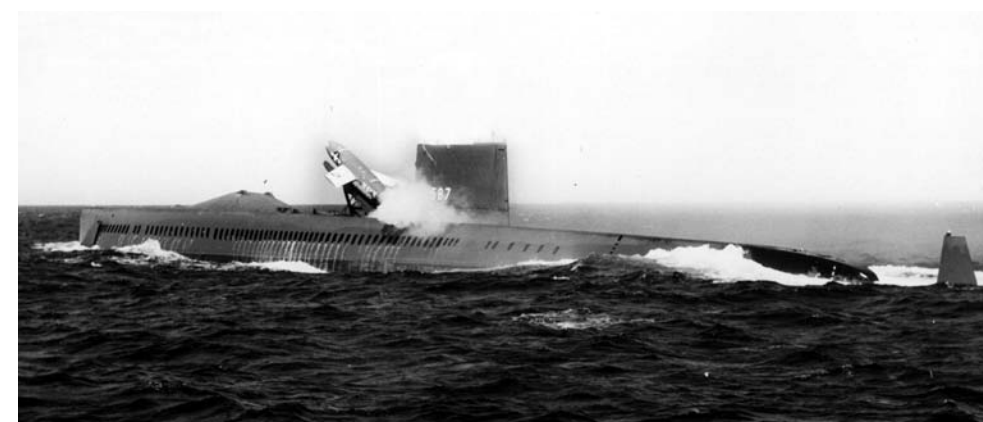
Lo Uss Halibut è stato un sottomarino a propulsione nucleare. Varato nel 1959, dal 1968 fu modificato per svolgere missioni di spionaggio. Venne perciò dotato di eliche laterali per manovre di precisione; camera di decompressione per immersioni in saturazione; apparecchiature di registrazione audio-video; pattini per posarsi sul fondale ecc. Ha quindi condotto operazioni ai danni dell'Urss tra cui intercettazioni telefoniche sul cavo che collegava le basi della penisola della Camciatca alla terraferma (1971-1980), nel Mare di Okhotsk ( Operazione Ivy Bells ).
